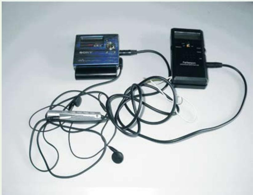
Un rilevatore di ultrasuoni collegato ad un minidisk consente la registrazione dei suoni emessi dai chirotteri e la loro successiva analisi con alcuni moderni *software* per personal computer.
