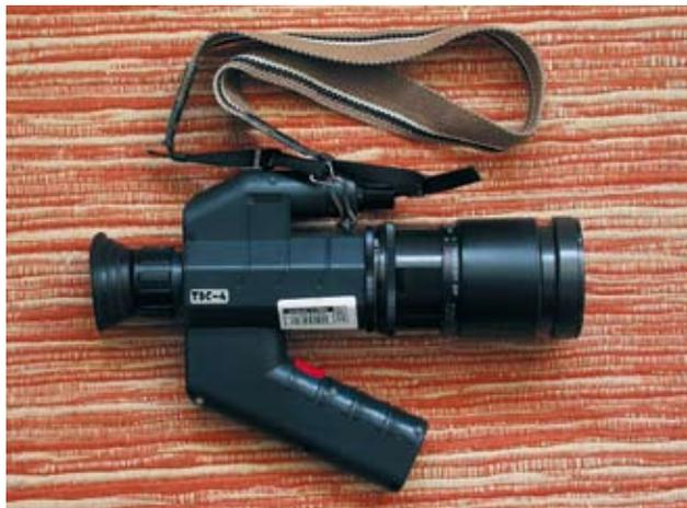
Un visore notturno ad intensificazione di immagine, dotato di ottica zoom 35-105 mm: con questo strumento si sono potuti osservare agevolmente pipistrelli dal volo lento e rettilineo, come il Vespertilio di Daubenton (*M. daubentonii*).
