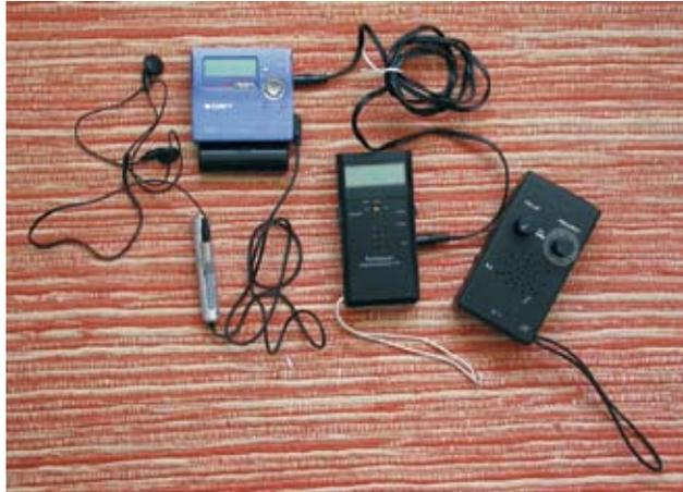
La strumentazione usata nel corso della nostra ricerca, per rilevare e registrare gli ultrasuoni emessi dai pipistrelli: si tratta di due “rilevatori in eterodina” e di un sistema di registrazione su minidischi digitali. Si sono potute rilevare e registrare oltre un migliaio di emissioni, su frequenze comprese tra 25 e 60 Mhz.
