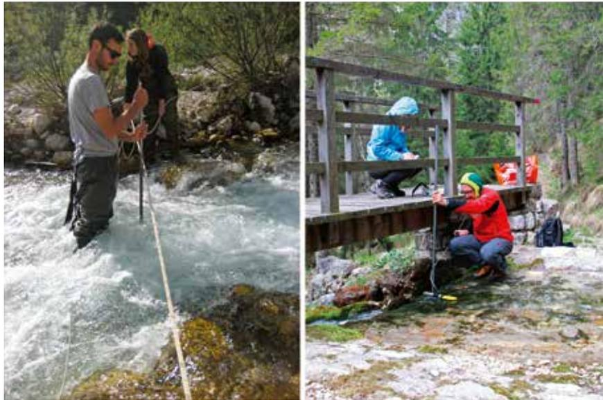
Fig. 10 - Misure di portata eseguite lungo il corso del Torrente Pradali.
