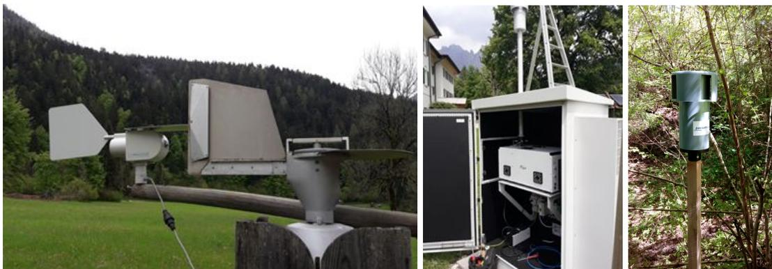
Figura 1: I campionatori aerobiologici utilizzati: campionatori volumetrici ( Burkard e Lanzoni) (sinistra); campionatore automatico Rapid-E (Plair) (centro); campionatore passivo Sigma-2 (Passam ag) (destra).
