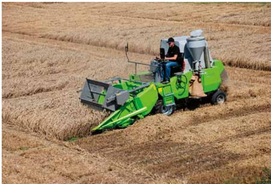
**Foto 2.5.2.3.** Mietitrebbie di piccole dimensioni come quelle delle prove parcellari di cereali possono essere impiegate anche per la raccolta del seme da praterie permanenti (Foto Wintersteiger AG).
