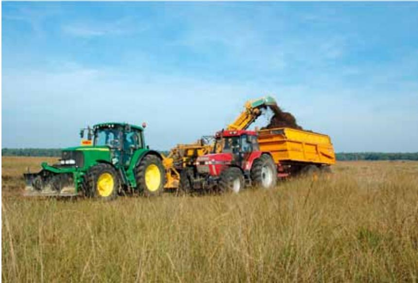
**Foto 2.6.3.1.2.** Asportazione dello strato superficiale di suolo ricco di propaguli con apposita macchina “strappatrice di suolo” (topsoil stripper) (foto Van de Haar Groep, Olanda).
