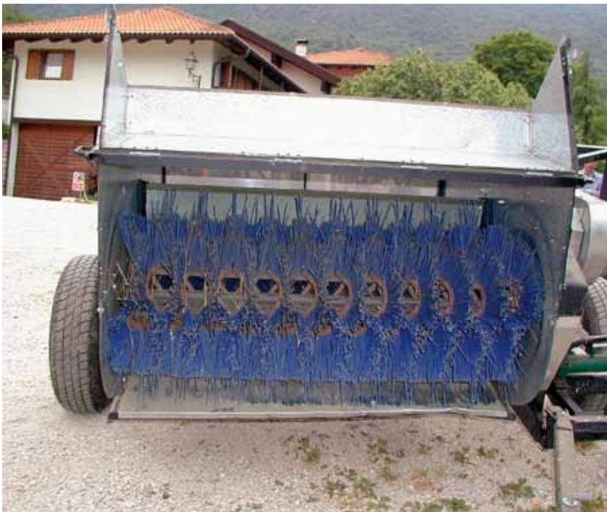
**Foto 2.5.2.2.** Spazzolatrice trainata. In primo piano la spazzola che ruotando strappa il seme dalle piante.
